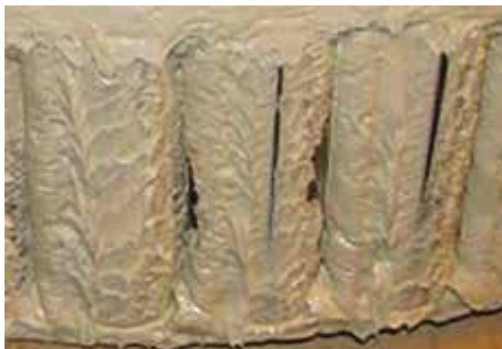
Figura 2: A graxa Mobil Centaur™ mantém a sua consistência e permanece em seu lugar sobre os rolamentos, mesmo com a absorção de água.
