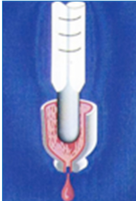
Imagem 4: Determinação do Ponto de Gota — Termômetro posicionado no recipiente para a determinação da temperatura na qual a primeira gota de óleo é liberada
