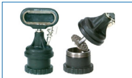
Imagem 1: Unidade de Teste de Graxa (Grease Worker) ASTM D217
